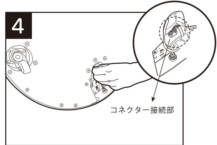
**4** ケーブルをベース台座裏面の穴を通し、コネクターに接続する
