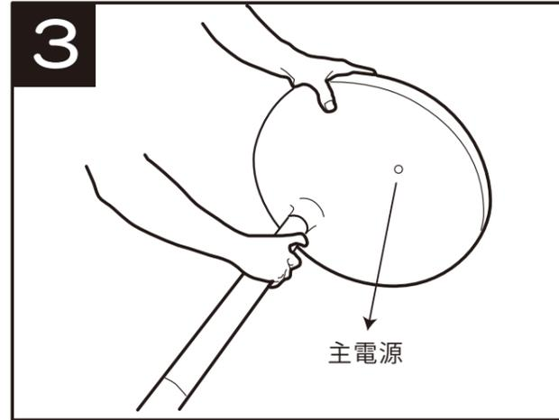
**3** 差し込んだブラケット (ポール) にベース台座裏面からネジを取り付ける。
